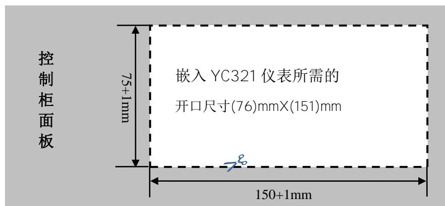
安装前请先将外壳两侧的顶杆拆下，然后将仪表由前面装入机柜中，将两只顶杆固定在仪表两侧，
